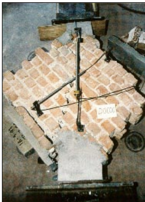
Εικόνα 8: Παραδοσιακή τοιχοποιία: Δοκιμή στο Εργαστήριο Σιδηροπαγούς Σκυροδέματος Α.Π.Θ.
